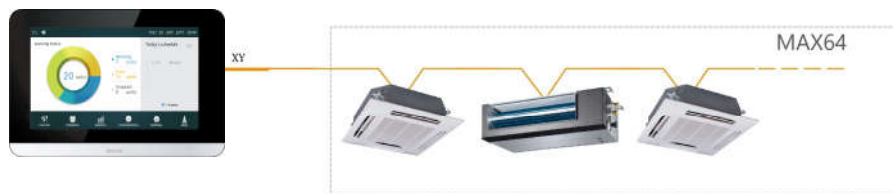
Abb. 7b: Zentralcontroller an den Inneneinheiten anschließen (erste Generation der AC/DC Inneneinheiten)
